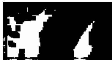
图3.2 膨胀腐蚀后的雷达栅格数据
